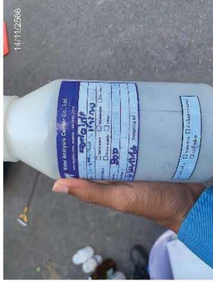
การเก็บตัวอย่างน้ำจุดน้ำเสียออกจากระบบบำบัดน้ำเสีย
